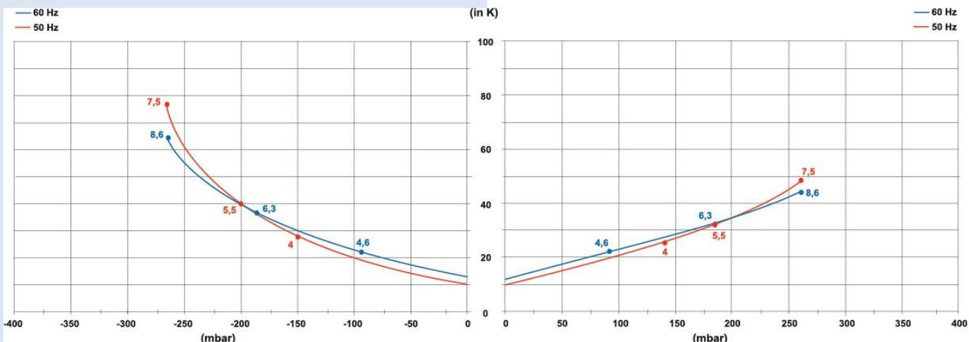
Die Kennlinien gelten für Dauerbetrieb; Medium: Luft von 15°C am Saugstutzen und einen atmosphärischen Gegendruck von 1013 hPa (mbar abs.), Toleranz: ± 10%; Zulässige Umgebungsbedingungen: -25° bis +40°C
