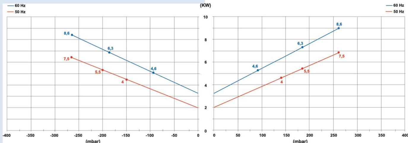
**Förderlufterwärmung / Temperature rise on the exhaust air**
