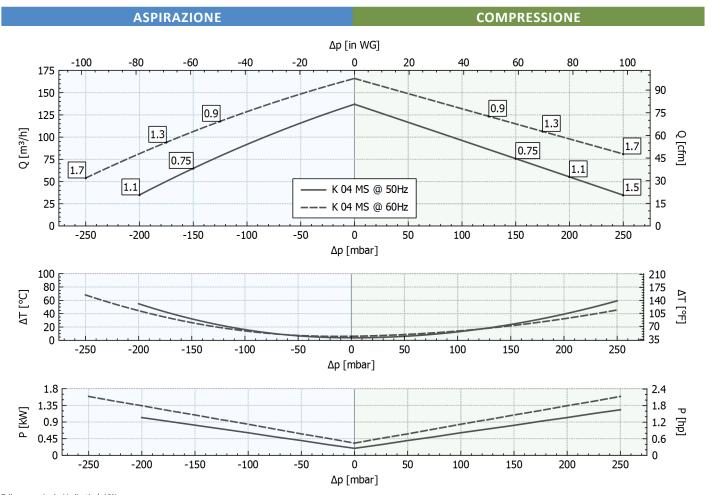
Tolleranza sui valori indicati +/- 10%. Dati soggetti a variazione senza obbligo di preavviso. Curve riferite ad aria ad una temperatura di 20°C e a pressione atmosferica di 1013 mbar (abs).
